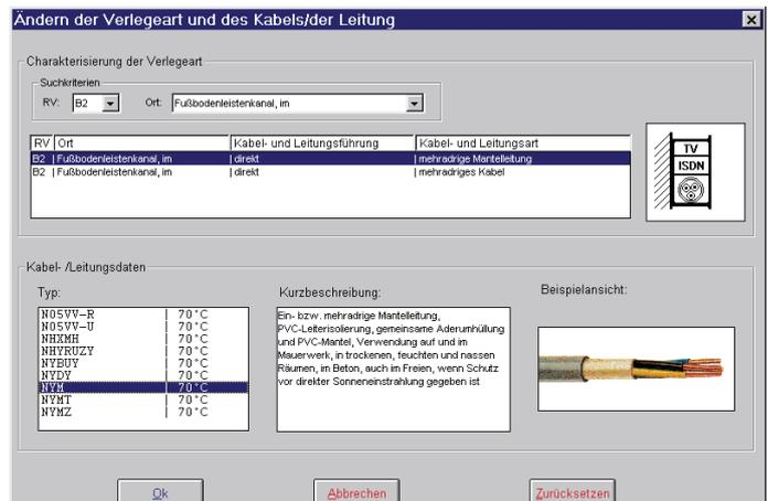
▲ Bild 3. Daten zur Verlegung von Kabeln und Leitungen
