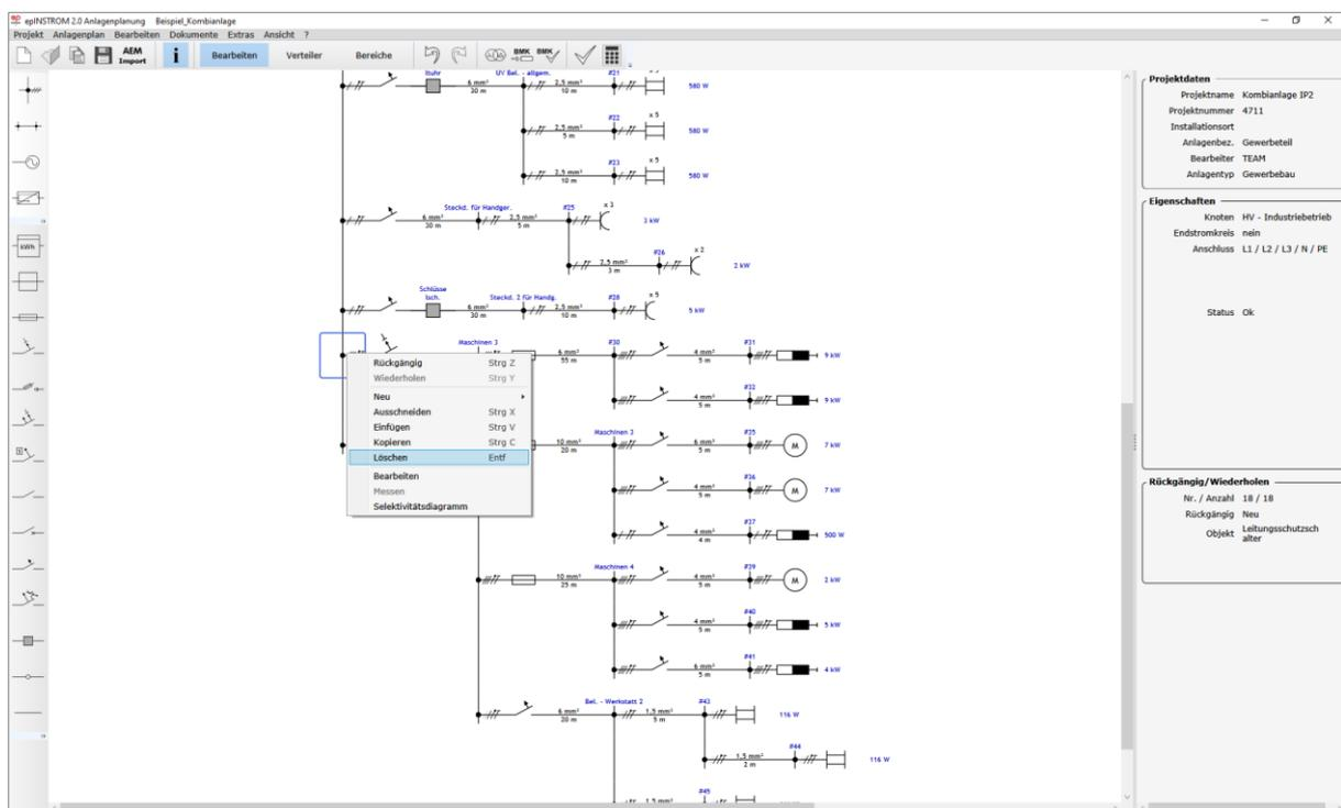
Nur dieser Netzweig wird gelöscht, das Teilnetz dahinter rückt an den davorliegenden Knoten. Wenn Sie ein ganzes Teilnetz löschen möchten, müssen Sie den ersten Knoten des Teilstranges markieren.
