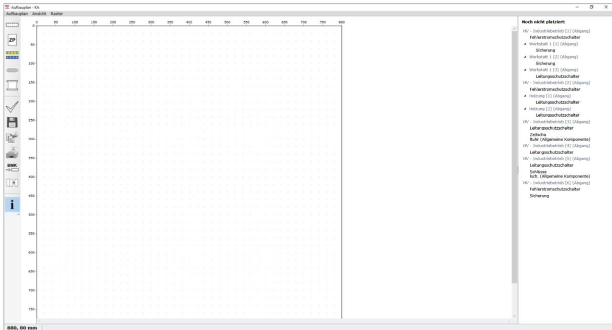
Im linken Bereich bleiben weiterhin die Werkzeugschaltflächen sichtbar. Der mittlere Bereich zeigt ein Punktraster. Hier werden Sie die Verteilerfelder planen und die Elemente in ihnen platzieren. Im rechten Bildschirmbereich sehen Sie die Liste derjenigen Elemente, die Sie für Ihre Verteilung definiert haben.
