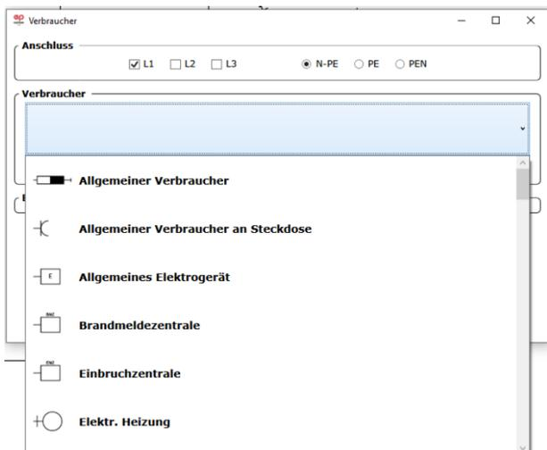
Je nach Typ des Verbrauchers gibt es Einstellmöglichkeiten für verschiedene Parameter. Bei einem Lampenstromkreis z. B. können Sie lediglich die Anzahl der Lampen und die Wirkleistung je Lampe eingeben.
