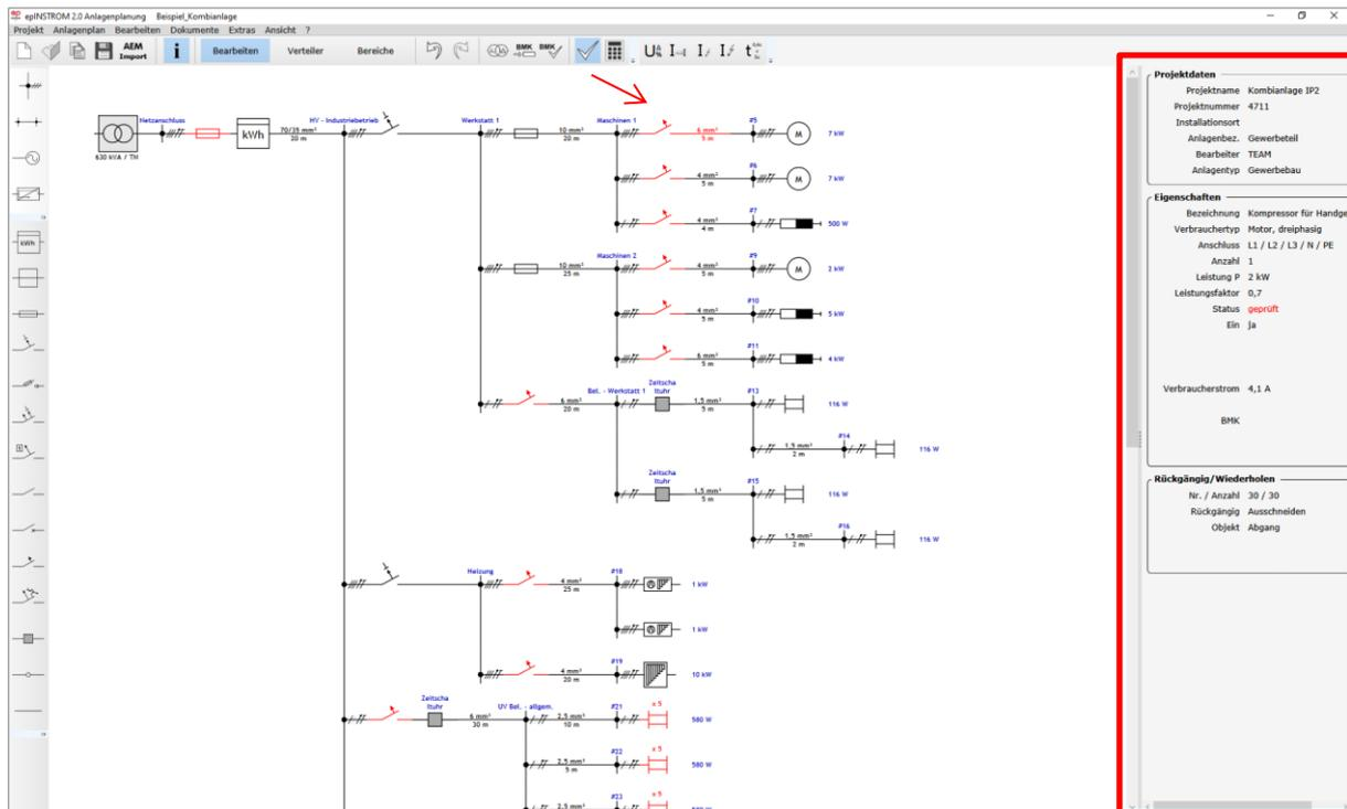
Im abgebildeten Beispiel beziehen sich die Eigenschaften auf den Knoten „Werkstatt 1“ (blau umrandet, oben in der Mitte). Ist die Anlage für den Wohnungsbau angelegt, werden die Angaben zum Kurzschlussstrom und zum Minimum der maximalen Abschaltzeit nicht angezeigt.
