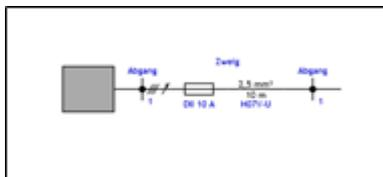
Als **Abgang** wird ein vertikaler Abzweig von einem Knoten bezeichnet. Das sind in der Regel die einzelnen Stromkreise einer Verteilung.
