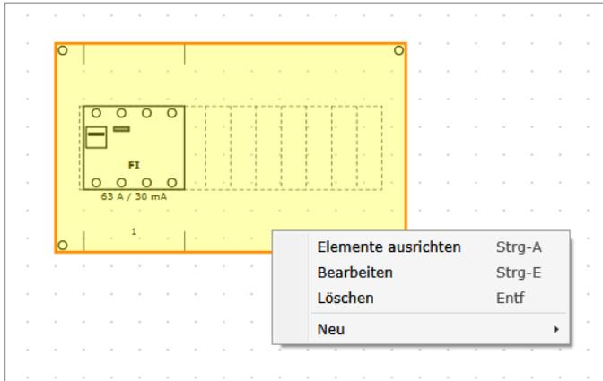
Jederzeit ist es möglich, die bereits im Feld abgesetzten Elemente so auszurichten, dass sie auf der Schiene genau nebeneinanderliegen. Dazu klicken Sie am besten mit der rechten Maustaste in einen freien Bereich des Verteilerfeldes, bis das ganze Feld gelb markiert ist.
