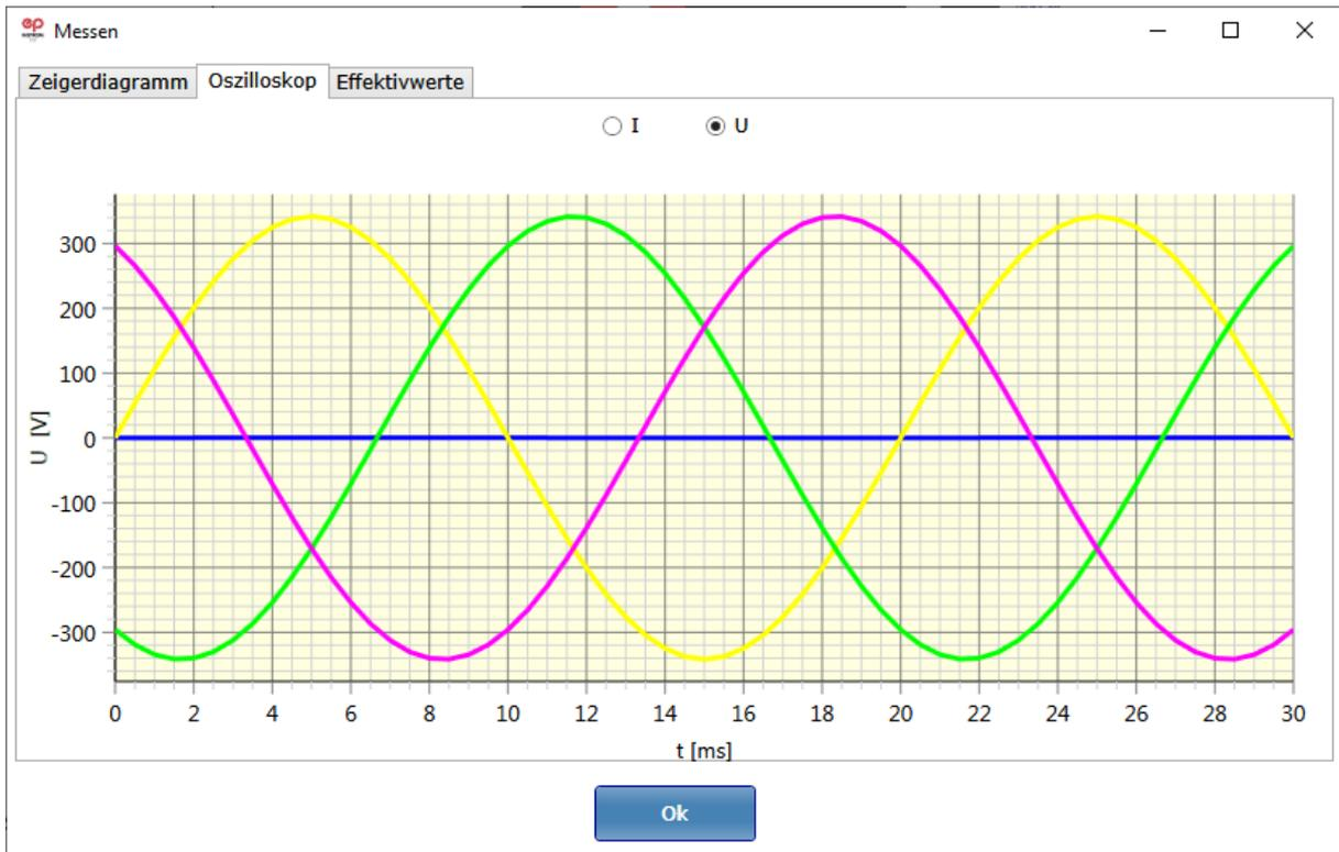
Im „Oszilloskop“ schalten Sie mit den Buttons „U[V]“ und „I[A]“ zwischen der Anzeige von Spannung und Stromstärke um.
