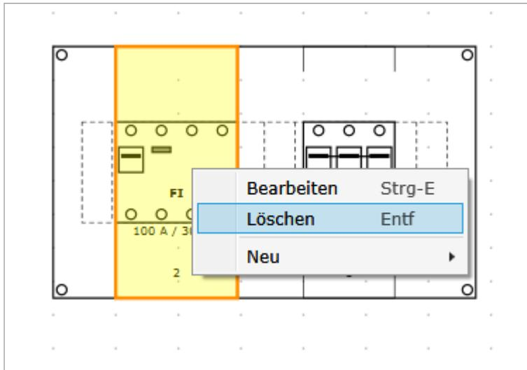
Möchten Sie ein Element wieder aus dem Verteilerfeld löschen, markieren Sie es wie oben beschrieben mit der rechten Maustaste und wählen Sie den Menüpunkt „Löschen“.
