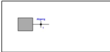
Der **Knoten** (Netzknoten) ist ein Punkt, an dem eine oder mehrere Leitungen weiterführen oder verzweigen. Das kann sowohl eine Verteilung als auch der Anschlusspunkt eines weiterführenden Leitungszweiges oder eines Verbrauchers sein. Der Knoten wird als Punkt dargestellt.
