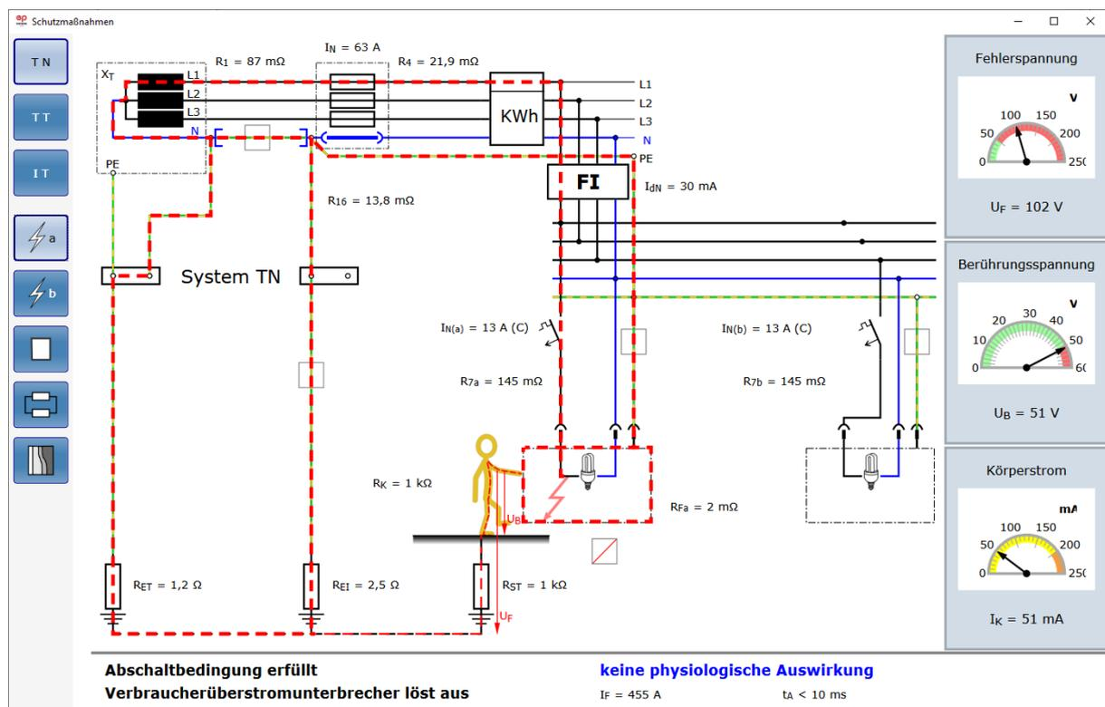
Die zugehörigen Ströme werden animiert dargestellt. Die Messgeräte zeigen die Fehlerspannung (Spannung über Person und Standortwiderstand), die Berührungsspannung sowie den durch den
