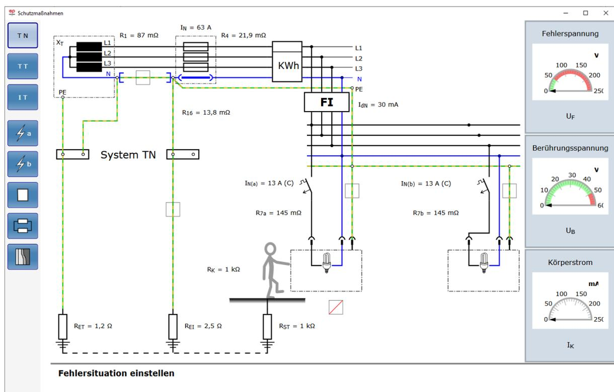
Die Umschaltung zwischen den Systemen erfolgt über die Schaltflächen oben links oder ein Klicken auf das angezeigte System. Der Muster-Plan ändert sich entsprechend.
