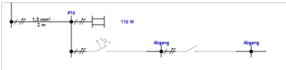
Wenn die Anlage für den Wohnungsbau angelegt ist, stehen die Symbole für Motorschutzschalter, Leitungsschutzschalter und Leistungsschalter nicht zur Verfügung. Das eingefügte Symbol ist zunächst noch grau dargestellt. Dies bedeutet, Sie haben noch keine Parameter dafür eingegeben. Zur Parametereingabe doppelklicken Sie bitte wieder auf das betreffende Symbol (oder Kli-
