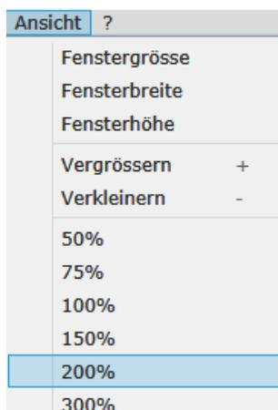
Über „Ansicht/Fensterbreite“ bzw. „Ansicht Fensterhöhe“ erfassen Sie den Plan in gesamter Breite bzw. Höhe. Sie können jetzt mit den Scrollbalken am unteren und rechten Bildschirmrand den Bildausschnitt verschieben. Über „Ansicht/Vergrößern“ bzw. „Ansicht/Verkleinern“ lässt sich die Darstellung ebenfalls vergrößern und verkleinern.
