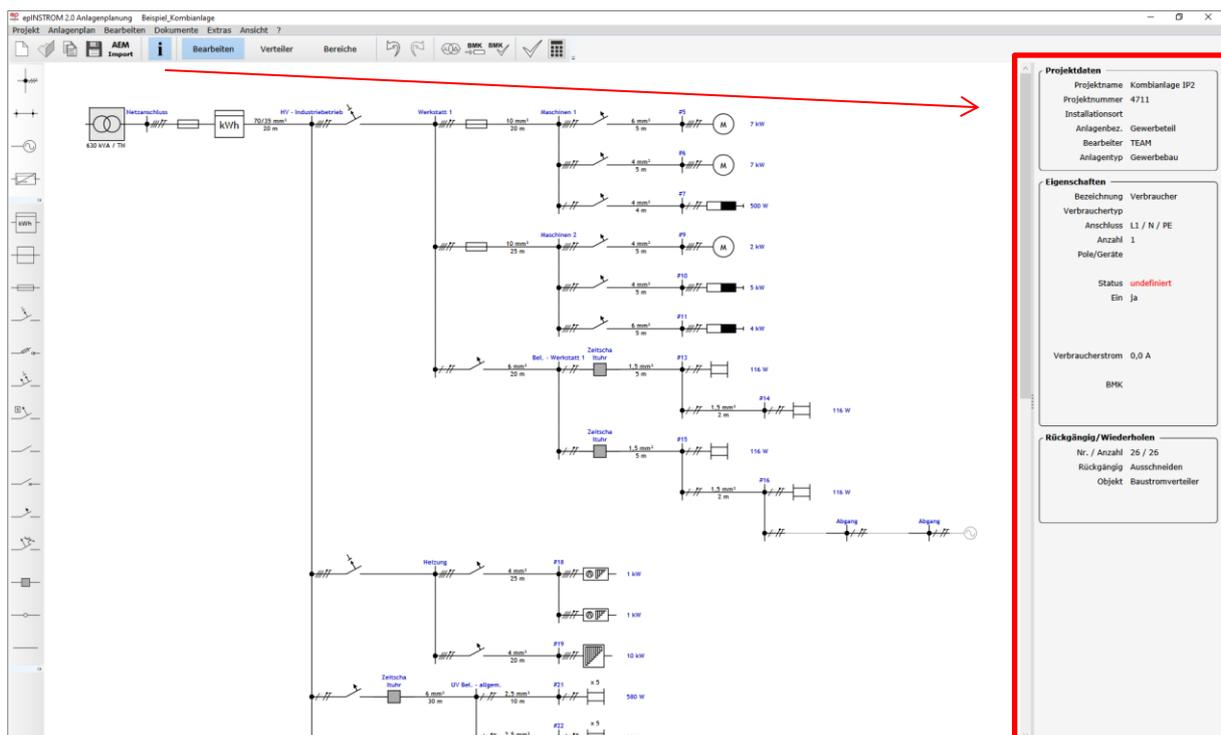
Der obere Bereich enthält die Angaben zum Projekt (Projektdaten). In der Mitte werden die Details zu dem Netzelement (Eigenschaften) angezeigt, das sich unter dem Mauszeiger befindet. Ist eine Prüfung durchgeführt worden, so werden hier auch die berechneten Werte und ggf. Fehlermeldungen angezeigt.
