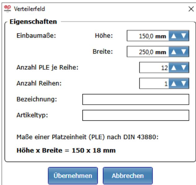
Legen Sie das Einbaumaß (Höhe und Breite) in mm fest. Oder definieren Sie die Breite der Schienen. Diese wird in PLE (Platzeinheiten) angegeben. Nach DIN 43880 misst eine PLE 150 mm in der Höhe und 18 mm in der Breite.
