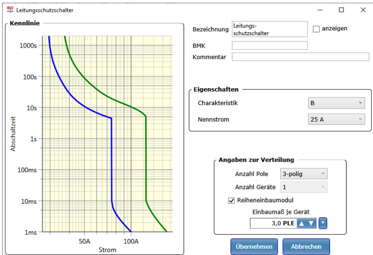
Sie wählen zunächst die Bauform und die Charakteristik sowie den Nennstrom aus den Klapplisten und sehen im Diagramm gleich die entsprechende Auslösekennlinie zur Kontrolle. epINSTROM achtet bereits bei der Auswahl auf Abhängigkeiten zwischen Bauform, Charakteristik und Nennstrom, so dass Sie nur plausible Sicherungen wählen können.
