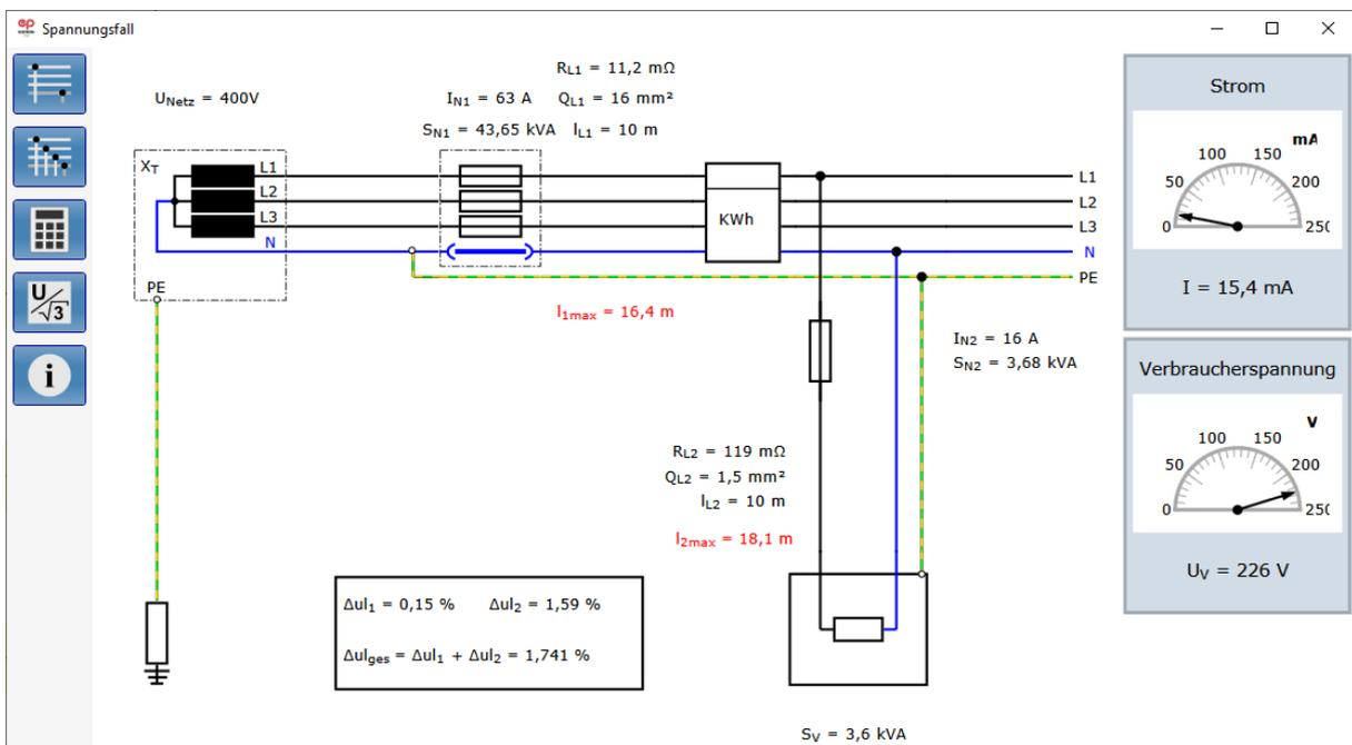
Hier können Sie die Parameter für die Hauptleitung (bis zur Zähleinrichtung) und die Stromkreisleitung (von der Zähleinrichtung bis zum Verbraucher) sowie die Nennströme der Sicherungen und die Leistung des Verbrauchers einstellen. Wenn Sie mit dem Mauszeiger über die Elemente
