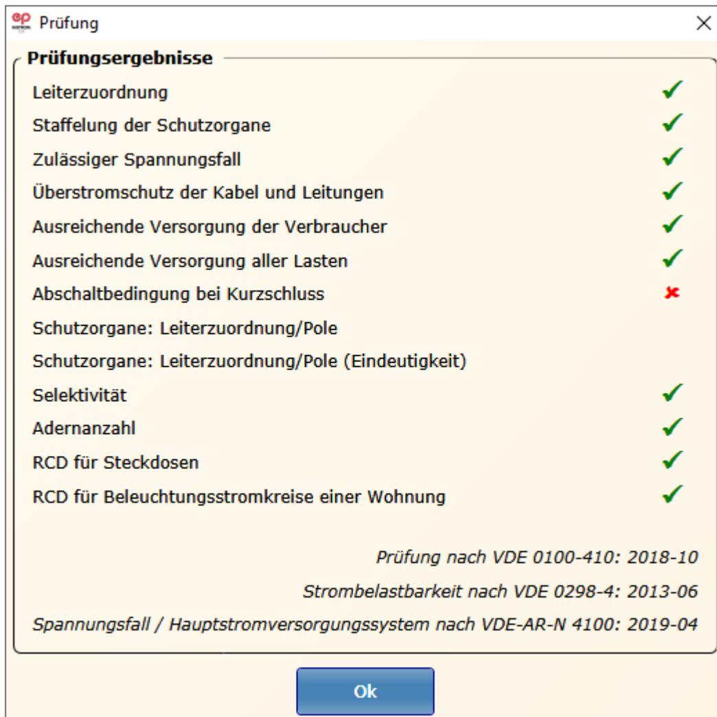
Sie können diese Funktion nutzen, um z. B. zunächst nur einzelne Prüfungen durchzuführen und die Dimensionierung Ihre Anlage ggf. zu ändern.
