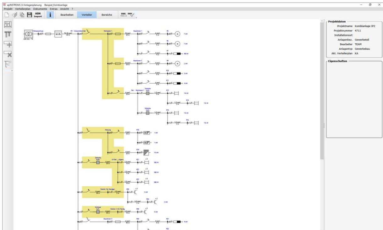
Damit ist die Definition einer Verteilung bereits beendet. Sie können nun den Verteilerplan in allpoliger Darstellung drucken (→ Kap. 6.2.), einen Verteileraufbauplan anlegen (→ Kap. 6.3.) oder eine weitere Verteilung definieren. Dazu wiederholen Sie die eben beschriebenen Schritte. Sie werden feststellen, dass epINSTROM die erste von Ihnen definierte Verteilung im Plan als helle graublau Fläche anzeigt, damit Sie immer den Überblick behalten.
