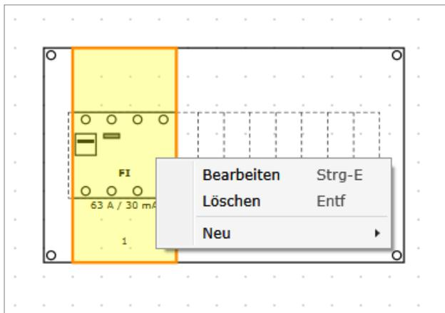
Manchmal ist es notwendig, Parameter der Elemente zu verändern, wenn Sie sich schon im Verteilerplan befinden. Sie müssen dazu nicht erst zurück in den Netzplanneditor, sondern können das auch im Verteileraufbauplan tun. Markieren Sie das Element mit der rechten Maustaste und wählen Sie im Kontextmenü den Punkt „Bearbeiten“.
