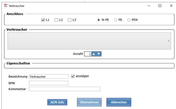
Im oberen Teil des Dialogfelds sind die zu diesem Knoten durchgeführten Leiter bereits markiert. In Abhängigkeit von der Leiterzuordnung stehen Ihnen in der Klappliste „Verbrauchertyp“ jeweils eine Auswahl an einpoligen, Wechselstrom- und Drehstromverbrauchern zur Verfügung. Im Feld darunter können Sie eine prägnante Bezeichnung vergeben.
