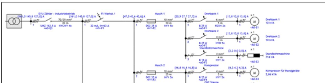
Der prozentuale Spannungsfall  $\Delta U$  wird in jedem Knoten kumuliert angezeigt.
