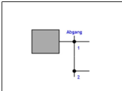
Als nächsten Schritt fügen Sie einen Abgang am ersten Knoten ein. Sie wählen einfach aus der Werkzeugleiste den Button „Verteilung“ und ziehen diesen mit der Maus auf den Knoten (Drag & Drop). Auf dem Plan erscheint sofort ein Abgang nach unten.
