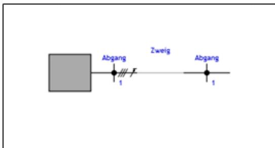
Um sich besser im Anlagenplan orientieren zu können, geben Sie dem Netzzweig eine Bezeichnung. Dazu klicken Sie den links vom Zweig liegenden Abgang an und kommen über „Bearbeiten / Bearbeiten“ oder mit der rechten Maustaste „Bearbeiten“ zum Eingabefenster.
