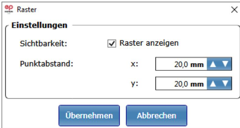
Mit „Raster anzeigen“ schalten Sie die Ansicht des Punktrasters ein bzw. aus. Setzen Sie das Häkchen hinter „am Raster ausrichten“, damit bereits platzierte Elemente sich am nächsten Rasterpunkt ausrichten.
