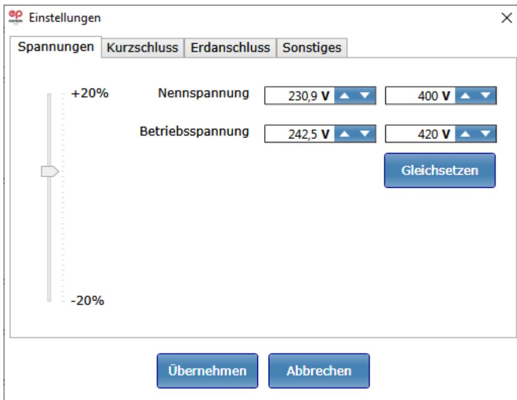
Unter Spannungen können Sie die tatsächliche Betriebsspannung in Abweichung von der Nennspannung einstellen. Dazu bewegen Sie den Regler auf der linken Seite mit der Maus nach oben und unten. Der Einstellbereich umfasst eine Abweichung von bis zu 20 % nach unten und oben. Sie können diese Einstellmöglichkeit z. B. auch nutzen, um die Berechnung unter den Bedingungen verminderter oder stark erhöhter Spannung durchzuführen.
