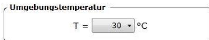
Die Umgebungstemperatur kann in 5-Grad-Schritten von 10 °C bis 95 °C eingestellt werden.
