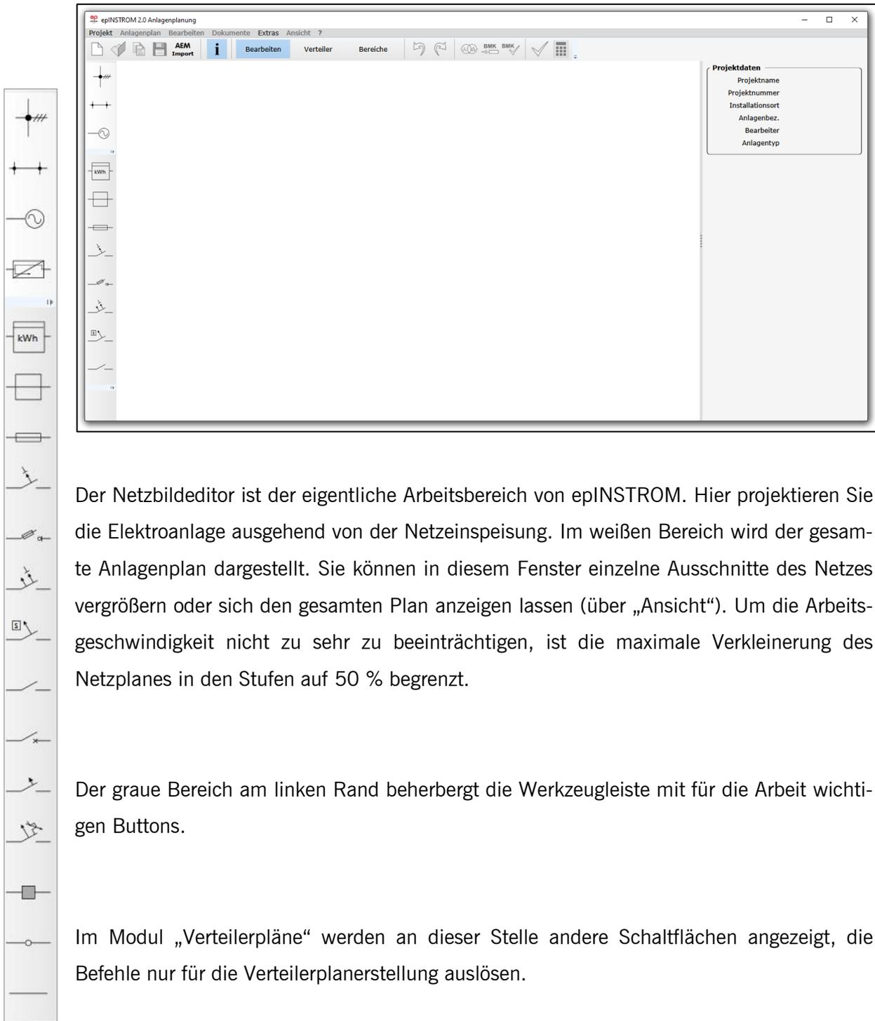
Der Netzbildeditor ist der eigentliche Arbeitsbereich von epINSTROM. Hier projektieren Sie die Elektroanlage ausgehend von der Netzeinspeisung. Im weißen Bereich wird der gesamte Anlagenplan dargestellt. Sie können in diesem Fenster einzelne Ausschnitte des Netzes vergrößern oder sich den gesamten Plan anzeigen lassen (über „Ansicht“). Um die Arbeitsgeschwindigkeit nicht zu sehr zu beeinträchtigen, ist die maximale Verkleinerung des Netzplanes in den Stufen auf 50 % begrenzt.
