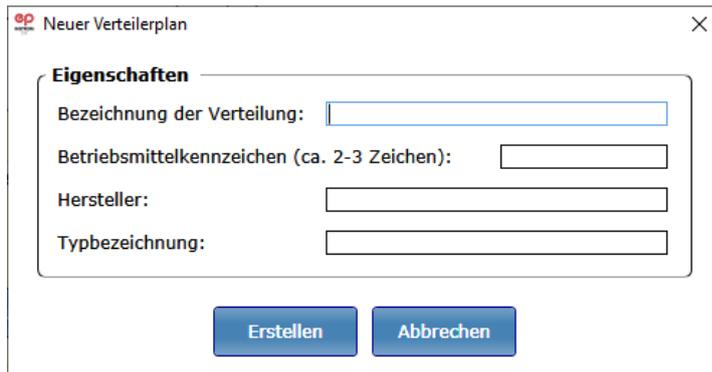
Sie müssen nun eine Bezeichnung für die Verteilung festlegen und ein Präfix, das bei der automatischen Vergabe der Betriebsmittelkennzeichnungen (BMK) verwendet werden soll (→ Kap. 4.2.2.5).
