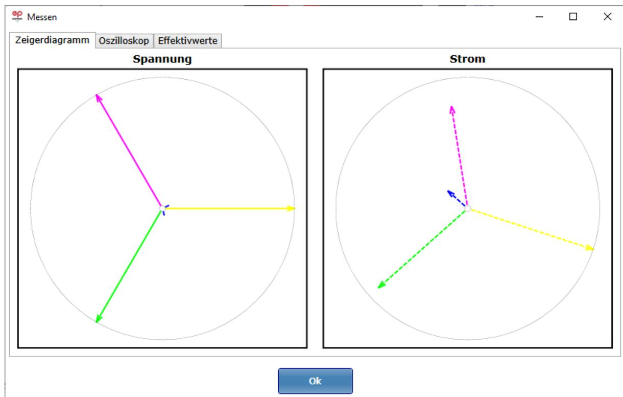
Zunächst sehen Sie die ermittelten Werte für Spannung und Strom als Zeigerdiagramm. Mit Hilfe der Reiter am oberen Rand können Sie sich das Ergebnis für Spannung und Strom auch als Oszilloskop-Darstellung oder als numerische Darstellung anzeigen lassen.
